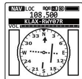
С GPS модулем, но без GP сигнала регистрируется направление взлетно-посадочной полосы.
