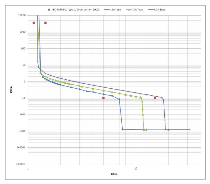
Ось X: кратное номинальному току (I / In). Ось Y: Время отключения без предварительной нагрузки, то есть ток был 0,0 ампер.
